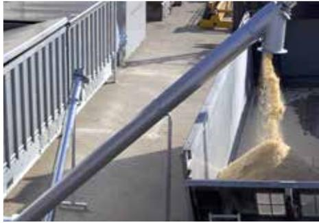
Hochförderschnecke mit Anschlußflansch zum Überladen auf z. B. Kipper, Container etc.
