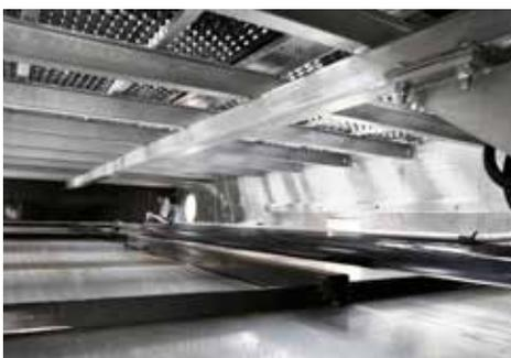
Schubkeilboden im Luftkanal zur Staubaustragung
