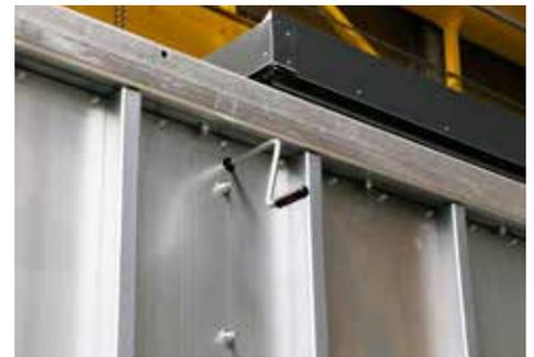
Verstellbares Schottor zur Regulierung der Fließhöhe und Luftführung
