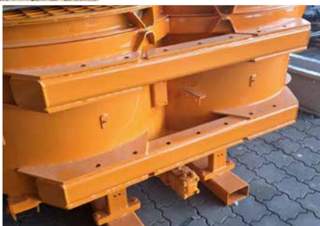
Anschraubkonsole aus zwei schweren waagerechten Rechteckrohren 1000 – 1400 I (Serie)
