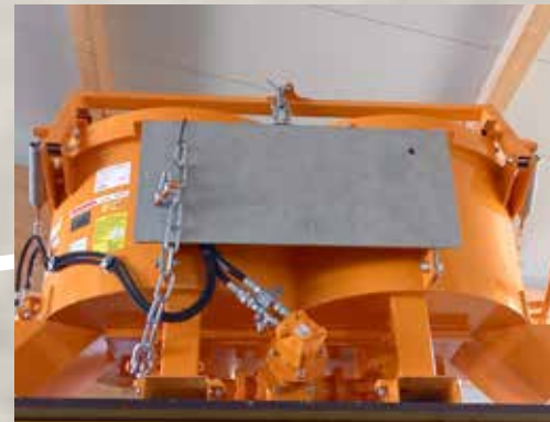
Grundkonsole verschraubt (optional) für bauseitige Anbringung der individuellen Radladeraufnahmen (400 & 600 l)
