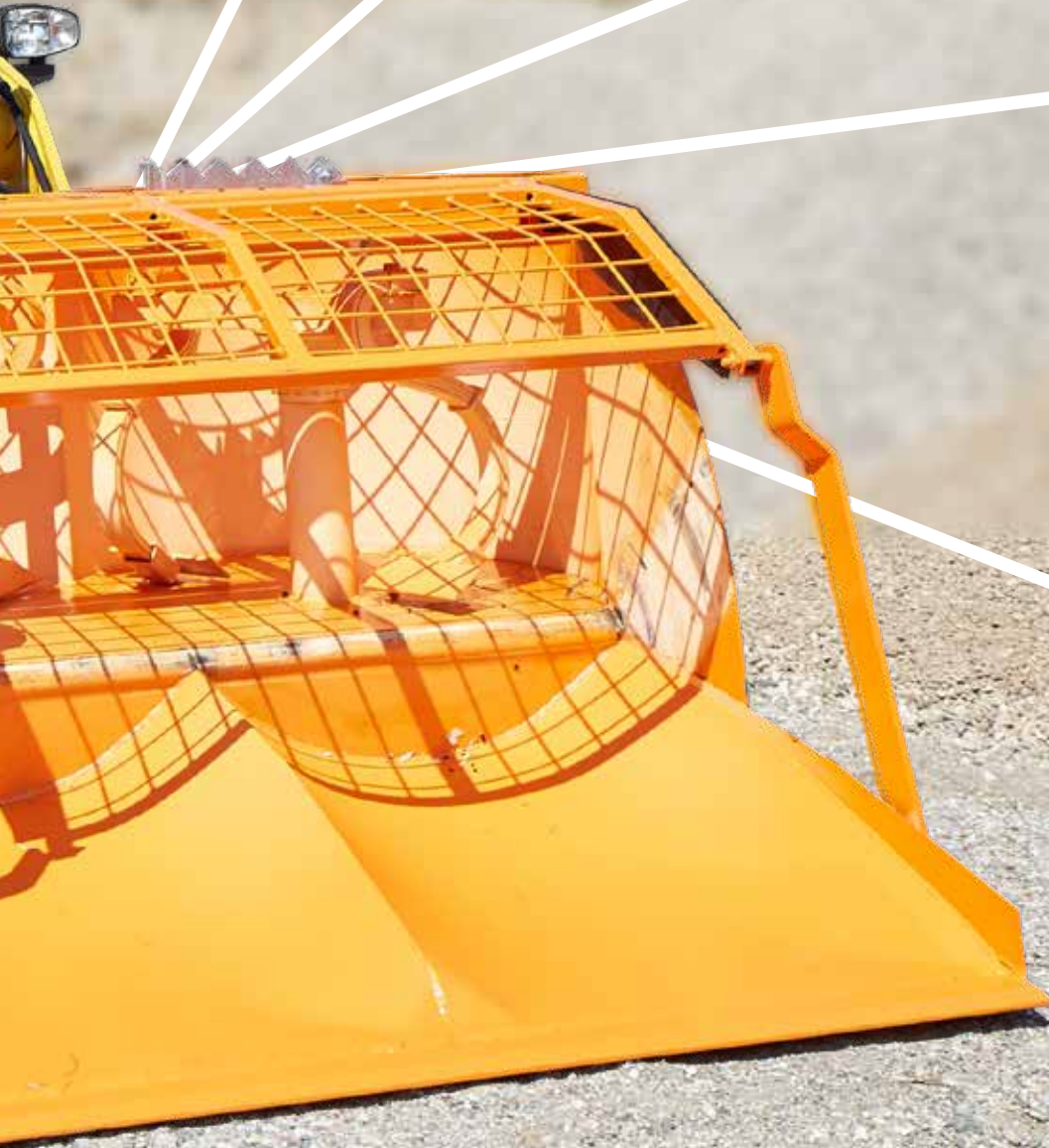
Grundkonsole verschraubt (optional) für bauseitige Anbringung der individuellen Radladeraufnahmen (400 & 600 l)
