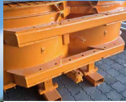
Anschraubkonsole aus zwei schweren waagerechten Rechteckrohren (Serie) 1000-1400 l
