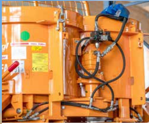
Anschraubkonsolen zum Befestigen der Radladeraufnahmen (Serie) 400 & 600 l
