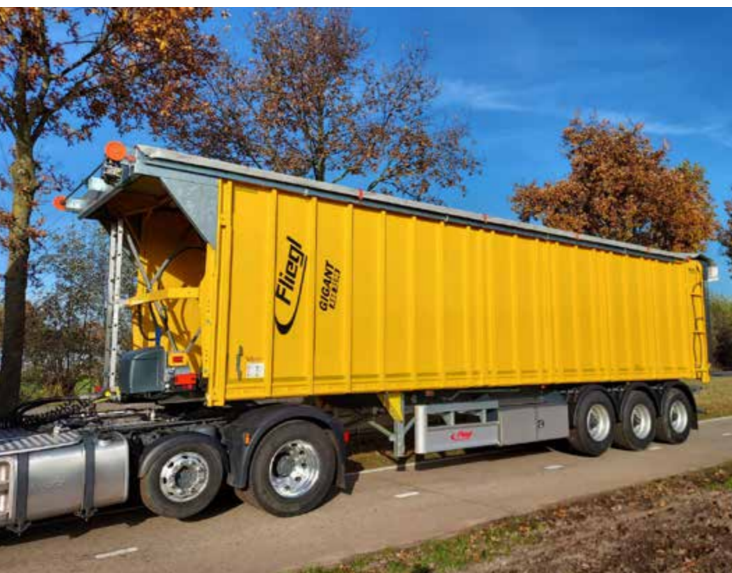
Toplift Light: zakrývací síť s vyklápěním do boku
