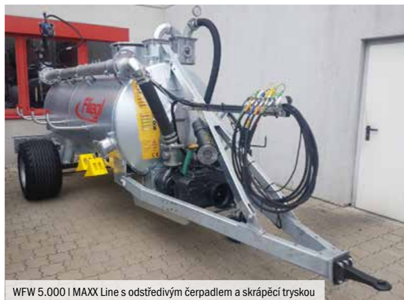
Skrápěcí tryska, hydraulicky výkyvná
