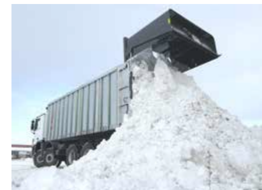
Dávkovaná vykládka hliníkových pilin v továrně na motory
