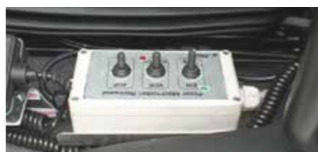
Hydraulické řízení přes ovládací pult (volitelné příslušenství)
