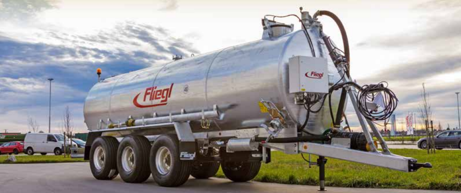
Wasserfass mit Schlauchhaspel und Regnerdüse
