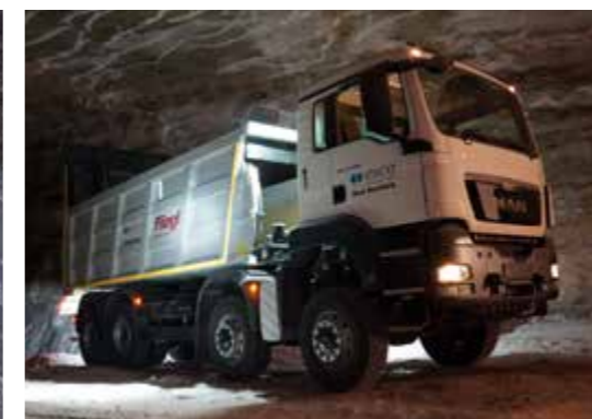
Použití v podzemních solných dolech: transport výplňového materiálu
