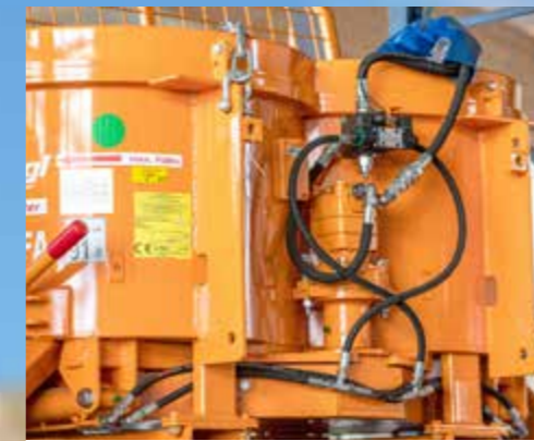
Našroubované konzoly pro připevnění uchycení kolového nakladače (standardně) 300-600 l
