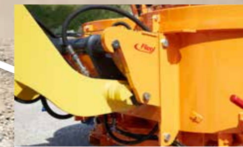
Upínání pro kolový nakladač, přišroubované (volitelné příslušenství) 300-600 l
