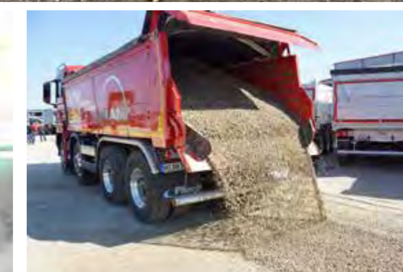
Bezpečné „vytahování“ při stavbě chodníků a silnic Středící plechy s šířkou posypu cca 2 m
