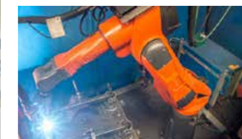
Nejlepší kvalita svárů díky použití svařovacích robotů
