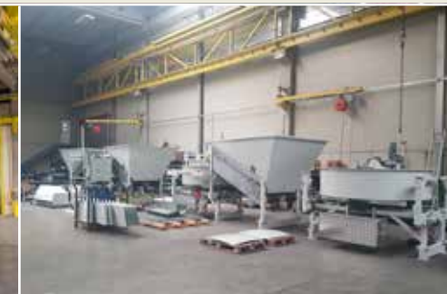
Endmontage von Betontankstellen
