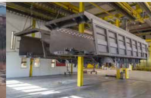
Lackvorbereitung durch Kugelstrahlen
