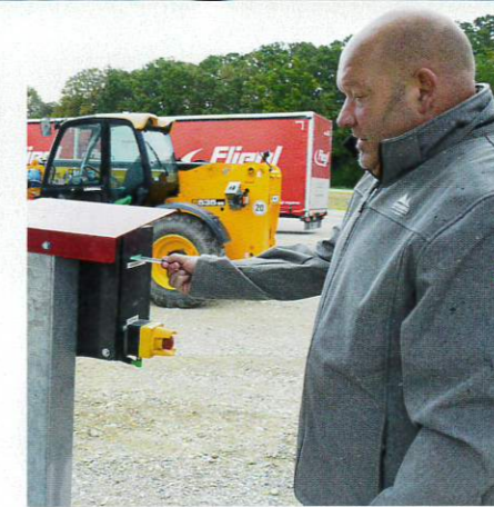
Karte rein und los geht's: Manfred Zwick von Treffpunkt.Bau beim Betontanken. Auf dem Chip sind Sorte und Bezugsmenge gespeichert. Zusätzliches Personal ist nicht nötig.
