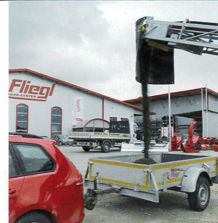
Nach 2–3 Minuten rauscht die gewählte Mischung in den Anhänger. Für längere Transportwege mixt die BTS auch einen Verzögerer dazu.
